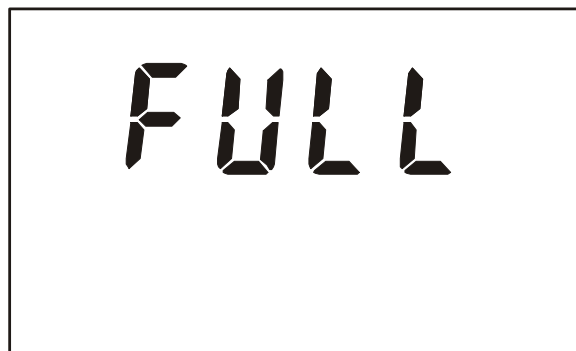
图 12-2 存储已满显示
